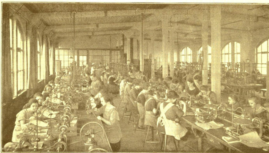
Polieren der Triebe.
